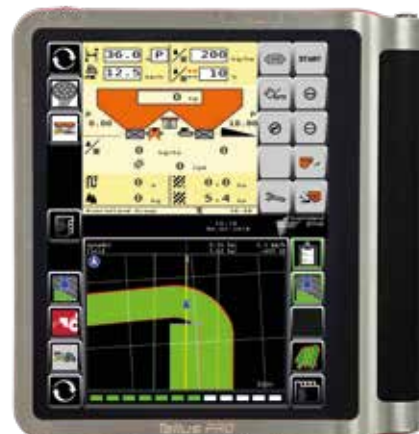
Automatische Drehzahlwarnung über das Terminal
