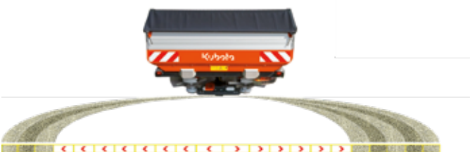
Abschalten der Teilbreiten von innen nach außen
