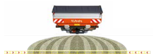
Verringerung der Streubreite auf beiden Seiten um 4 m
