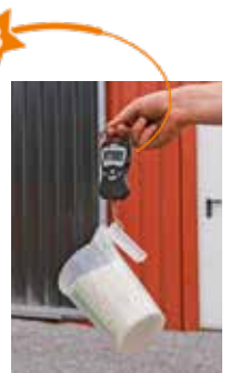
Bestimmung des spezifischen Gewichts
