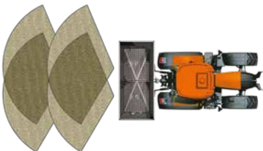
Andere Hersteller: Zwei Streuschaufeln pro Scheibe (Schlechte Verteilung des Düngers in Hanglagen durch eine Veränderung des Aufgabepunktes auf den Streuscheiben.)
