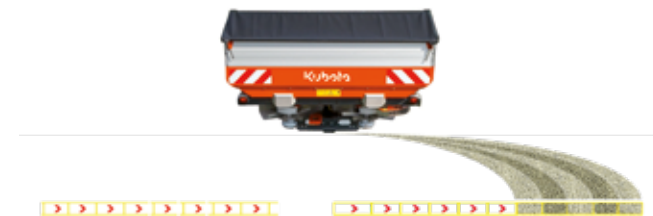
Von links nach rechts Teilbreiten abschalten über die Mitte hinaus
